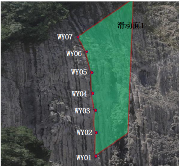
图6 实际风化岩节理边坡顺层滑坡监测点设置图
