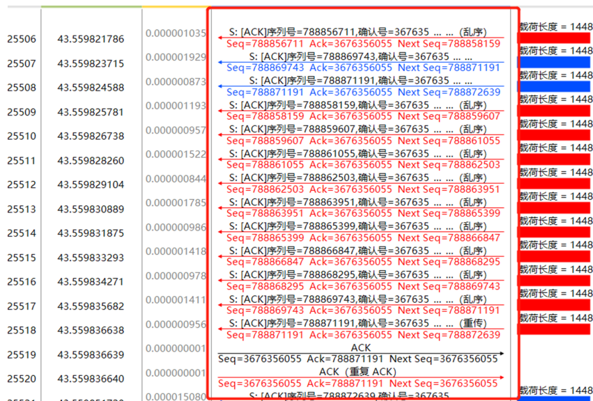
图13 系统故障监测——数据包乱序与重传
