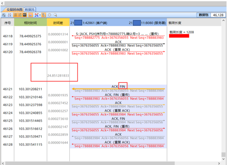
图12 系统故障监测——TCP会话链接异常
