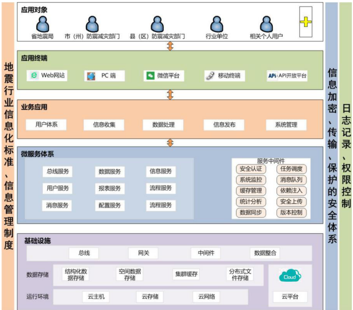
图1 四川地震应急信息共享服务系统架构图 Fig.1 Architecture diagram of SEEISS
