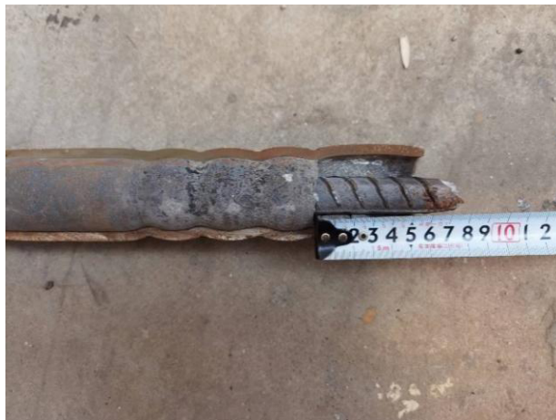
图 3 灌浆套筒内灌浆料崩裂情况
