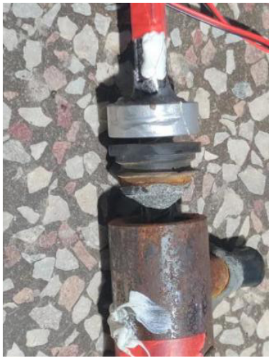
(b)钢筋拔出破坏
