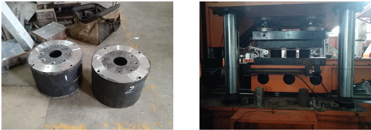
(a)厚层橡胶支座 (b)试验操作过程
