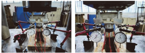
(a)变形前 (b)变形后 图11 四点受压性能试验
