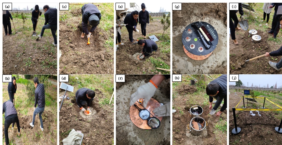
(a) 敲击实验; (b) 台基挖掘; (c) 台基夯实; (d) 敲击耦合; (e) 寻北定向; (f) 校正磁偏角; (g) 调节水平; (h) 触发测试; (i) 回填; (j) 防水处理, 现场整理
