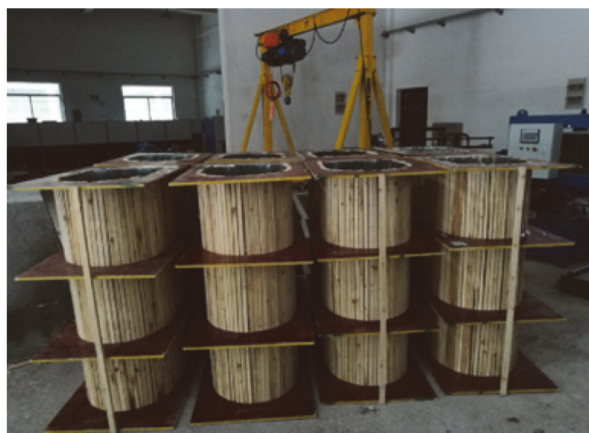
图2 隧道模型(养护待拆模)
