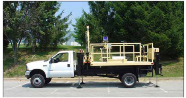
图7 多功能数字式车载SCPTU系统照片
