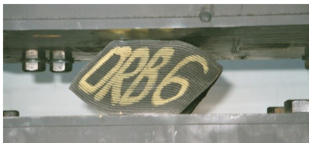
图6 纤维叠层橡胶隔震支座的压剪试验 [27]
