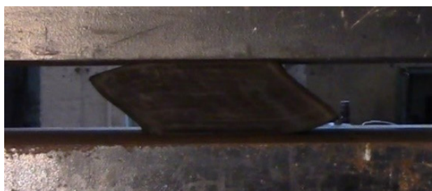
图7 FRP 叠层橡胶隔震支座的压剪试验 [40]
