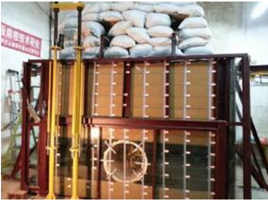
图 5 堆载下衬砌变形图模型试验 [6]
