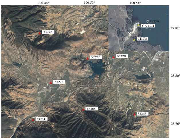
图 2 宾川气枪发射台及流动地震观测台网。图中红色三角形为本文使用的流动台站, 黄色三角形为参考台。
