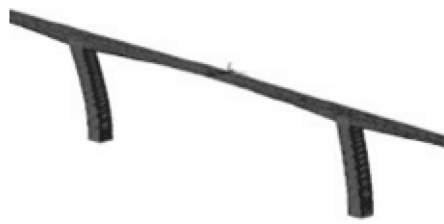
图 1 实验对象一阶正对称横弯振型 Fig.1 First-order positive symmetry transverse bending mode
