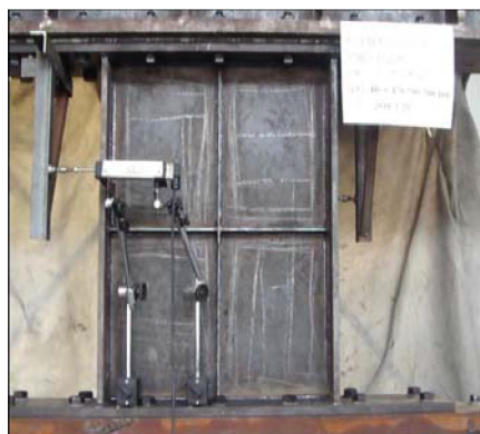
图 8 试验试件布置图
