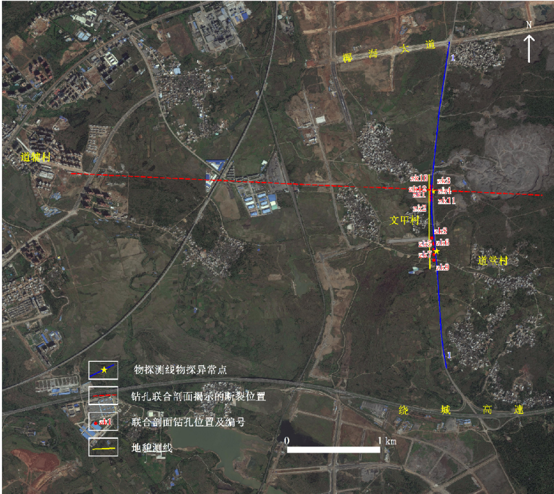
图 3 地球物理勘探线、地貌测线及钻孔位置平面图
