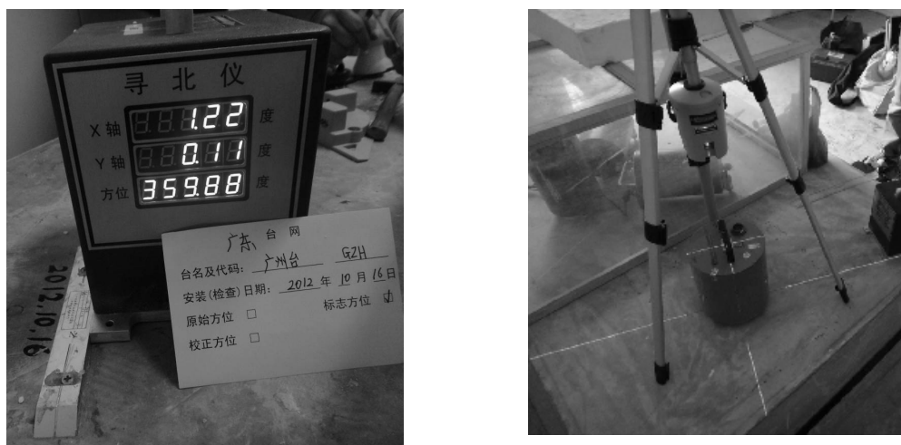
图 2 现场工作相片 (左为广州台永久性标志安装测量, 右为台山台地震计 N 向方位角测量)
