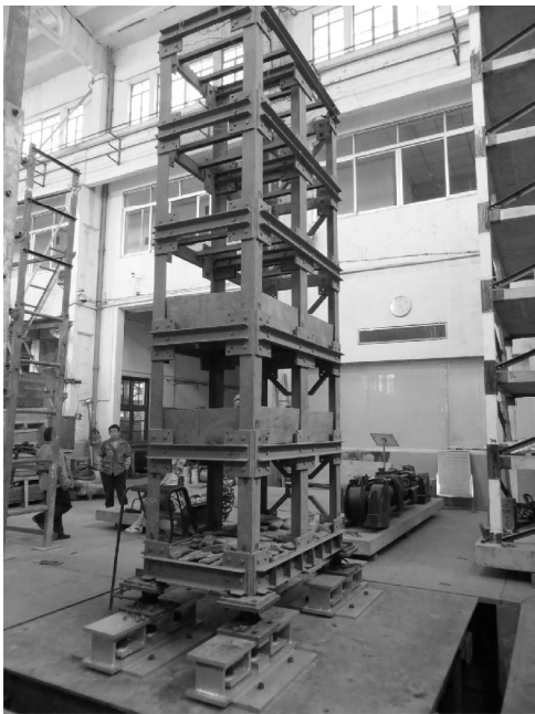
图 4 安装有新型抗拉机构的结构模型
