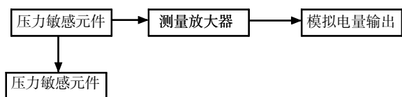
图5 压力传感器构成框图
