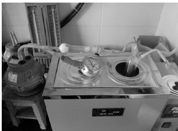
图 2 利用恒温水浴制水样水温进行脱气观测
