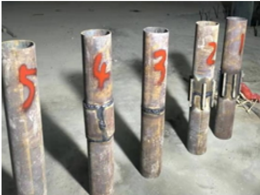
图 1 钢管试件 Fig.1 Test piece of steel pipe
