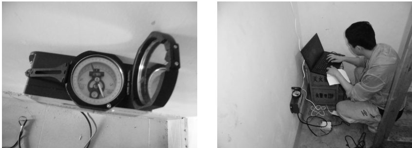
图 6 测量安装方位角、配置网络及台站参数
