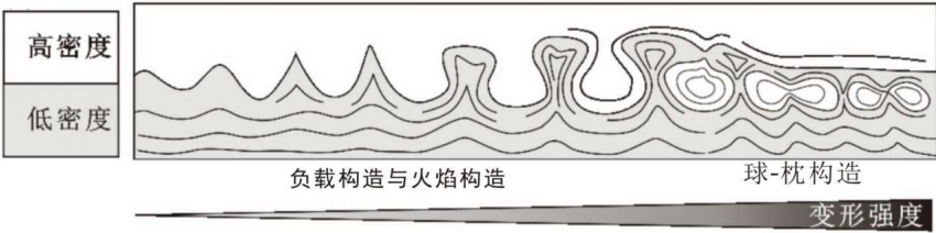
图 5 不同形态液化砂岩脉和重荷模—火焰状构造形成条件示意图( 据文献[20],有修改) Fig.5 Schematic diagram of boundary conditions of different sand dykes(according to[20],modified)
