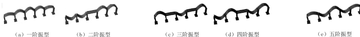
图7 盆式支座桥梁振型图
