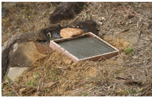
图 5 不平整基岩测点浇混凝土摆墩图
