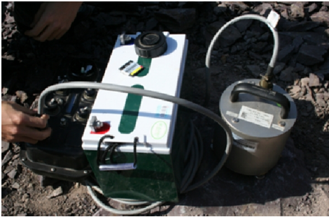
图 4 基岩测点仪器安装图
