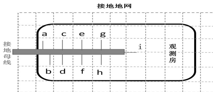
图 4 地线连接布局图
